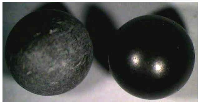
\text{Si}_3\text{N}_4 - Kugeln vor und nach dem Schleifen
